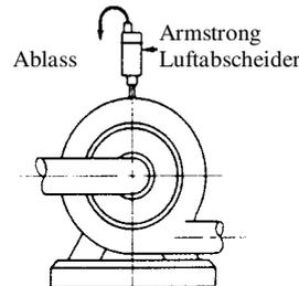
Fig 2-6. Entlüftung an einer Zentrifugalpumpe.
