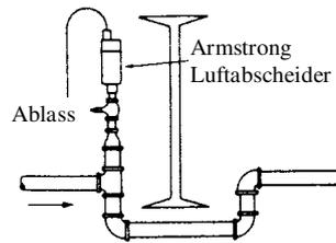
Fig 2-3. Installation des automatischen Luftabscheiders an einer Krümmung der Rohrleitung
