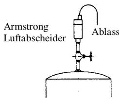
Fig 2-5. Installation an einem Lager oder Sammel-tank.
