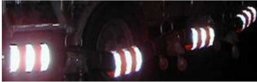
Ein wesentlicher Bestandteil einer sicheren Flugzeugbetankung ist ein gutes Erkennen der im Einsatz befindlichen Schläuche. Hydranten-Eingangsschläuche müssen bestens `sichtbar` sein, um das Risiko von Beschädigungen durch andere im Betankungsumfeld befindliche Fahrzeuge zu minimieren. Eine gute `Sichtbarkeit` der Betankungsschläuche, insbesondere wenn diese noch mit dem Flugzeug gekuppelt sind, kann ausschlaggebend sein, wenn es um die Vermeidung von -Wegfahr-Unfällen- geht.
