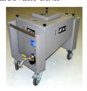
Der PRT hat einen komplett abnehmbaren Deckel, der mit 4 Rändelmuttern befestigt ist, durch ihn ist ein schneller Zugriff zum Reinigen des Tanks möglich. Im Deckel befindet sich eine quadratische 300 mm große Öffnung für schnelle Eimerentleerungen. 100 mesh Filter, der 100 mm in den Tank eingelassen ist. Der Filter kann vollständig demontiert werden, sollte das Drahtgeflecht einmal ersetzt werden müssen. Die Einfüllöffnung ist ebenfalls mit einem abnehmbaren Deckel versehen.
